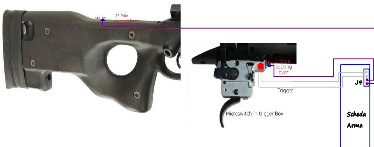
Effettuata la modifica colleghiamo la batteria che deve essere una Lipo 7,4V 25-50 almeno 1500mAh ed accendiamo l'elettronica lasertag tramite l'apposito tasto (1).
